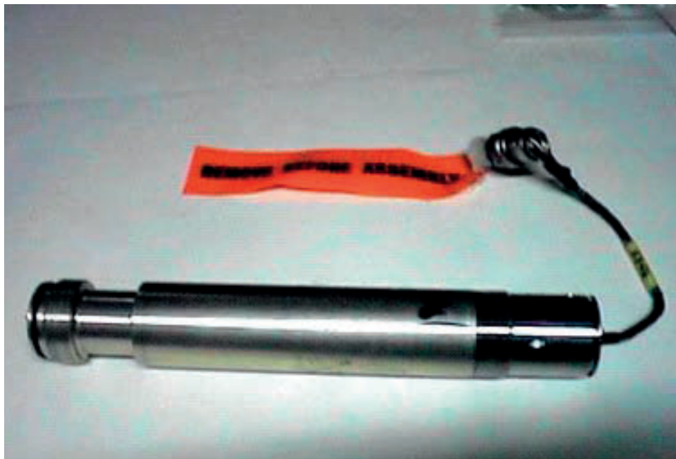
FIGURA 6.9 SISTEMA DE SEGURO Y ARMADO DE UN MISIL
