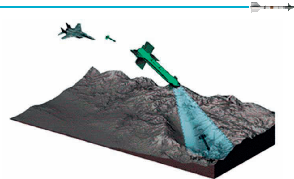
FIGURA 7.22 ESQUEMA DE GUIADO POR TV
