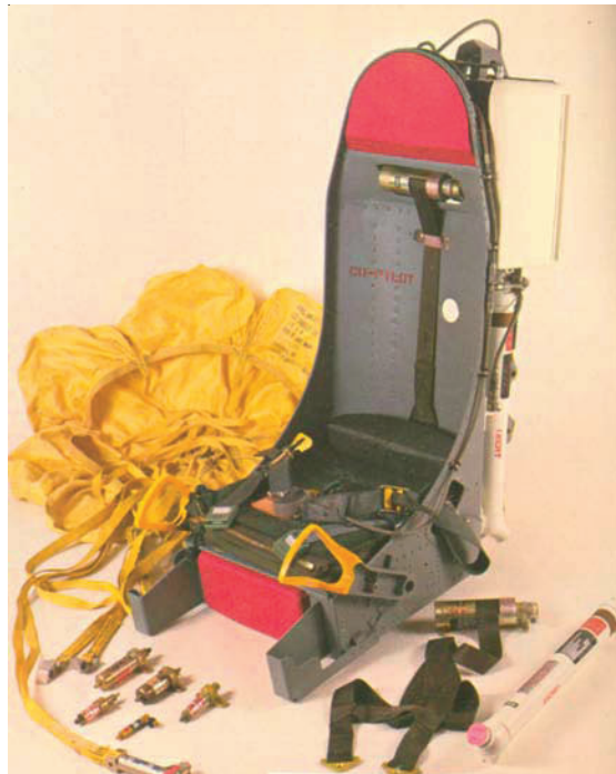
FIGURA 8.2 VISTA FRONTAL DEL ASIENTO EYECTABLE DE UNA AVIÓN A-37 DRAGONFLY
