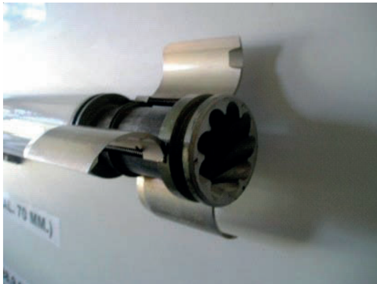
FIGURA 5.11 ALETAS DEL MOTOR COHETE DESPLEGADAS
