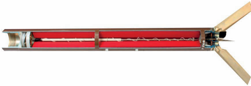
FIGURA 5.10 DISPOSICIÓN DEL PROPELENTE AL INTERIOR DE MOTOR DEL COHETE
