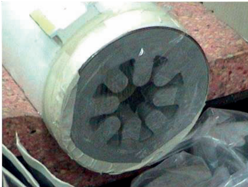
FIGURA 2.6 MOTOR UN MISIL COMPUESTO DE PROPELENTE HOMOGÉNEO
