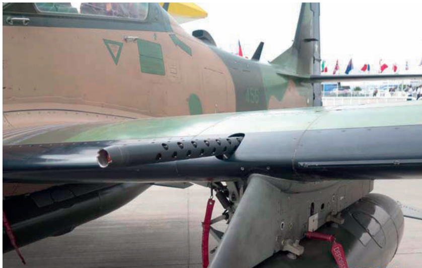
FIGURA 3.4 AMETRALLADORA ACCIONADA POR RETROCESO DE MASAS EN AVIÓN A-29 SUPER-TUCANO
