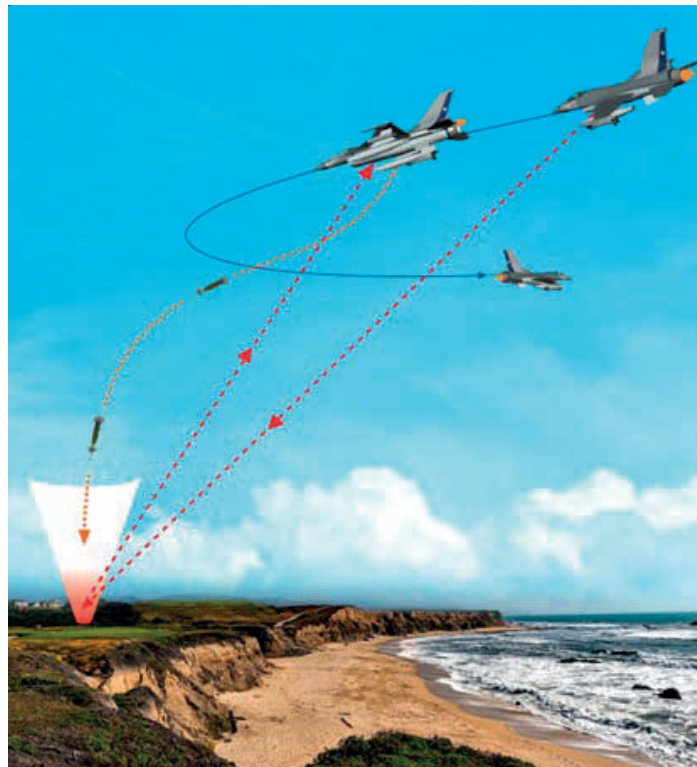
FIGURA 7.20 ESQUEMA DEL GUIADO POR LÁSER
