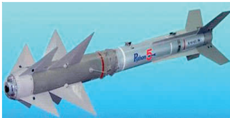
FIGURA 6.8 ALAS MÓVILES Y FIJAS DE MISIL PYTHON V
