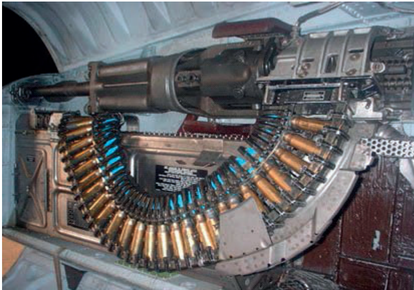
FIGURA 3.7 CAÑÓN TIPO REVÓLVER DE 20 mm
