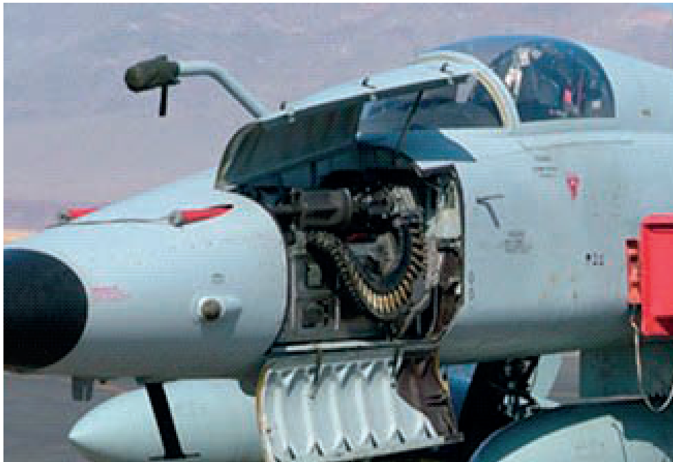
FIGURA 1.10 CAÑÓN TIPO REVÓLVER M-39, FABRICADO POR EE.UU.
