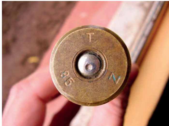
FIGURA 2.3 CÁPSULA INICIADORA DE UNA MUNICIÓN YA PERCUTADA
