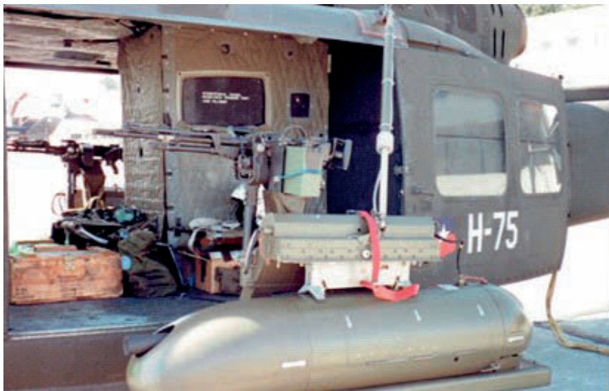
FIGURA 3.6 AMETRALLADORA ACCIONADA POR TOMA DE GASES
