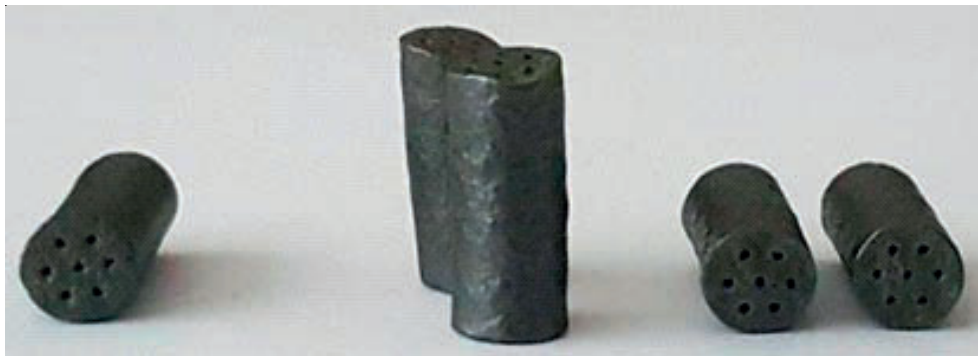
FIGURA 2.5 GRANO TUBULAR MULTIPERFORADORA DE PÓLVORA BASE TRIPLE
