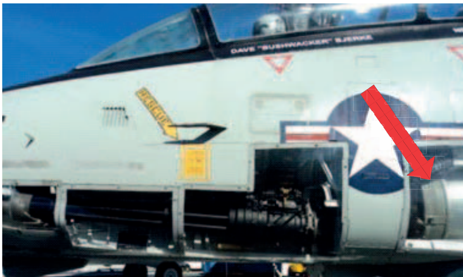
FIGURA 3.10 TAMBOR DE ALMACENAMIENTO DE MUNICIÓN QUE UTILIZA EL AVIÓN F-14
