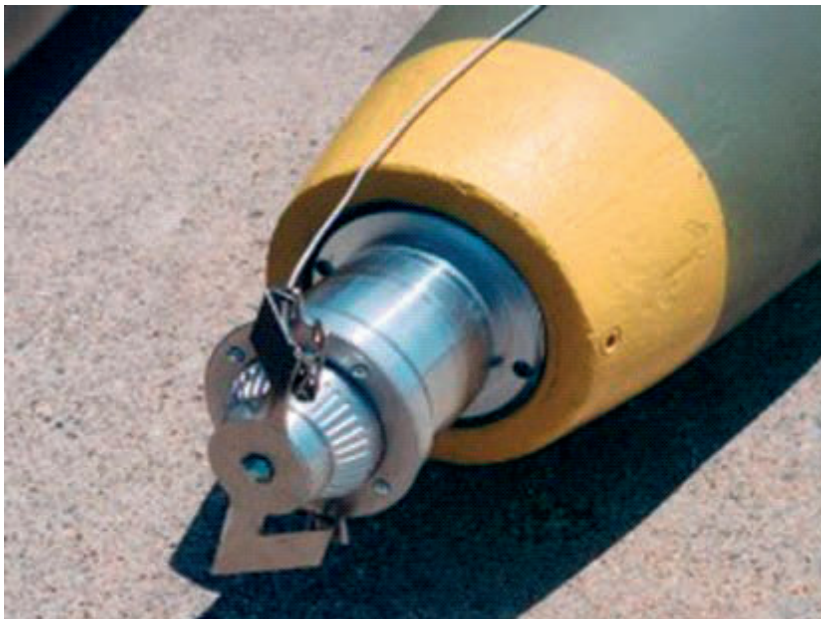
FIGURA 7.6 ESPOLETA M-904 (INSTALADA EN BOMBA DE AVIACIÓN TIPO MK)
