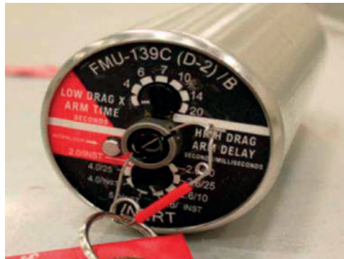
FIGURA 7.9 ESPOLETA ELECTRÓNICA FMU-139
